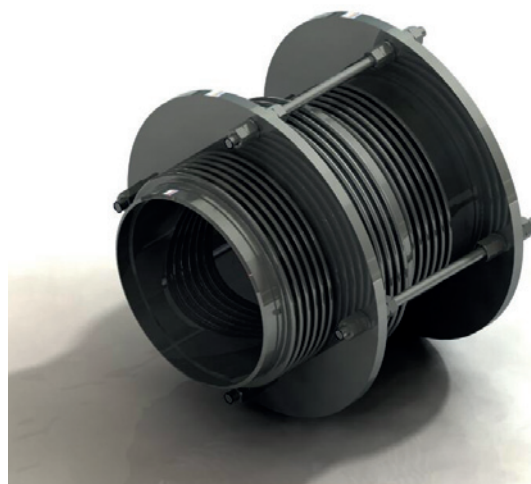
MPB-I priamy tlakovo vyvážený kompenzátor. Zachytáva axiálne a laterálne pohyby pričom eliminuje sily od vnútorného pretlaku. Používa sa v priamych kompenzačných úsekoch.
